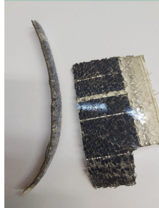
Panel fotowoltaiczny przygotowany do recyklingu (z potłuczoną warstwą szklaną)
