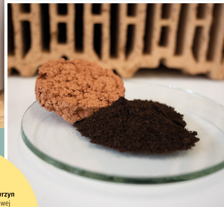
Fusy z kawy oraz otrzymane z ich dodatkiem tworzywo ceramiczne
