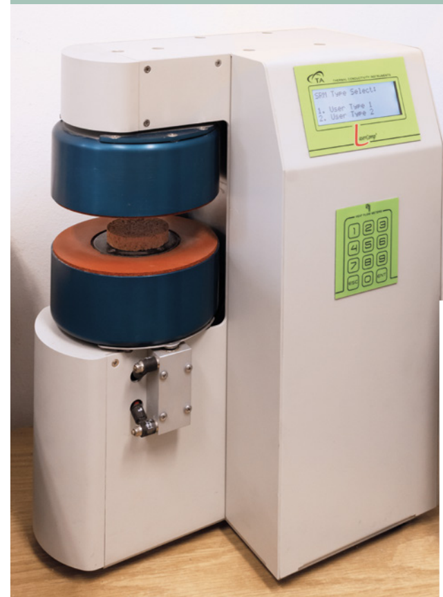
Aparat płytowy do badania współczynnika przewodzenia ciepła tworzyw otrzymywanych z gliny i fusów kawowych, pracujący w zakresie przewodności od 0,1 W/(m·K) do 10 W/(m·K)
