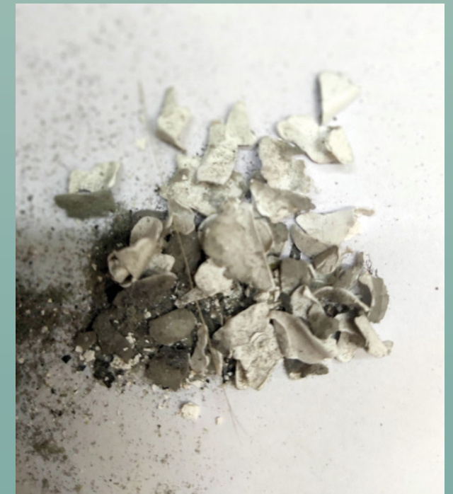
Folia uszczelniająca EVA wydzielona z panelu metodą termiczną (ogrzanie do ok. 60%)
