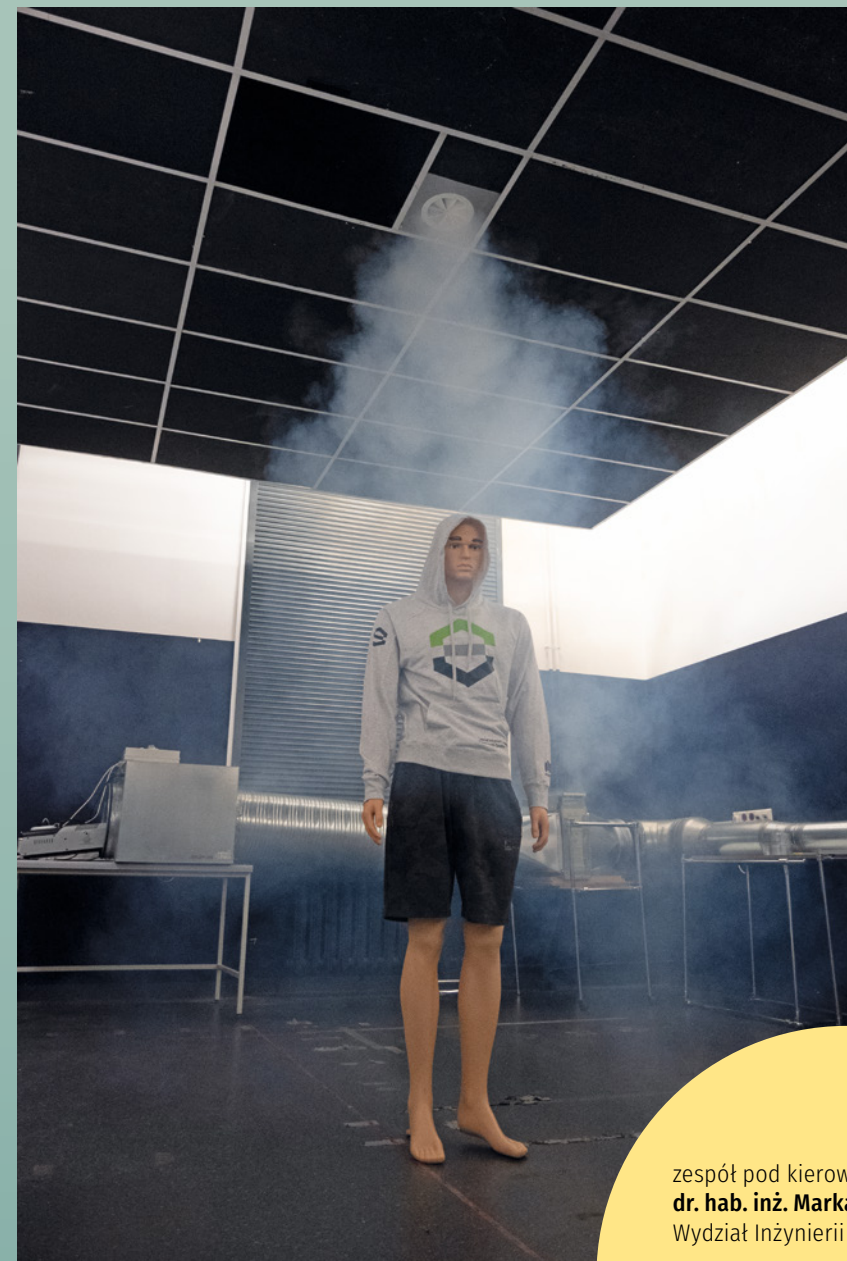
Test dymowy służący wizualizacji rozptywu powietrza nawiewanego wokół manekina
